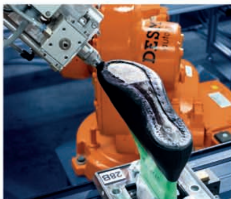
Etapa donde la herramienta de trabajo se traslada al corte armado.
