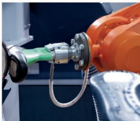
Asentado del fondo. El proceso inverso, donde el corte armado se traslada a la herramienta.
